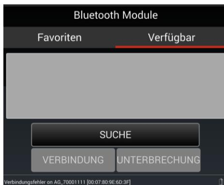
Unter dem Tab **VERFÜGBAR** suchen Sie nach dem Bluetooth-Modul, das der Seriennummer Ihres Messgerätes entspricht (z.B: AG\_70000010), durch Drücken auf Taste **SUCHE**, danach bauen Sie die Verbindung auf mittels Taste **VERBINDUNG**.
