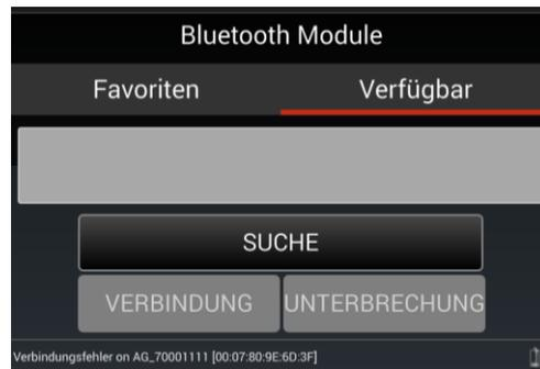
Unter dem Tab **VERFÜGBAR** suchen Sie nach dem Bluetooth-Modul, das der Seriennummer Ihres Messgerätes entspricht (z.B: AG\_70000010), durch Drücken auf Taste **SUCHE**, danach bauen Sie die Verbindung auf mittels Taste **VERBINDUNG**.
